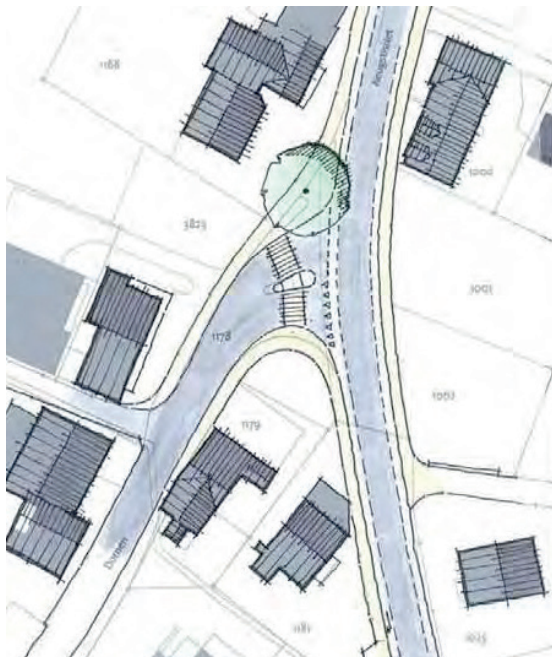
Massnahmenskizze: Redimensionierung Knoten Augstisriet/Dornen, damit die Fahrzeuge im Bereich des Fussgängerstreifens langsamer unterwegs sind.
